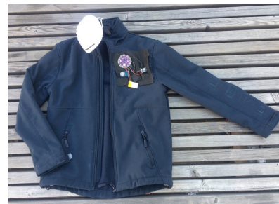
Jacke zur Messung der Luftqualität, entwickelt vom Breathtaking Team
